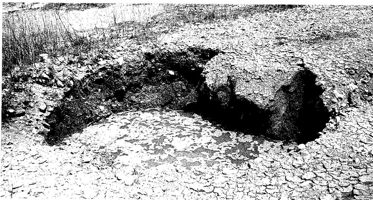
Hundimiento de los depósitos detríticos en la terraza inferior del río Jarama, provocado por la extracción de aguas subterráneas del acuífero kárstico subyacente. (Canal de Isabel II. 1994.)
